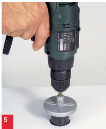
5. Mit dem Kreisbohrer das Loch von oben bohren.
