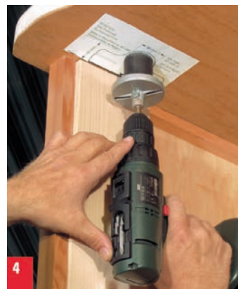
4. Mit dem Kreisbohrer ein Loch von Ø 38 mm von unten bohren.
