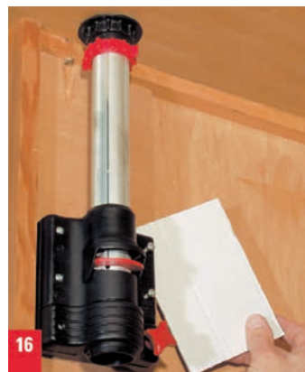
16. Falls Antennenmast sich schwer schieben lässt, Unterlage anbringen oder abschleifen.
