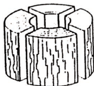
Dachverstärkung in Form eines Holzringes
