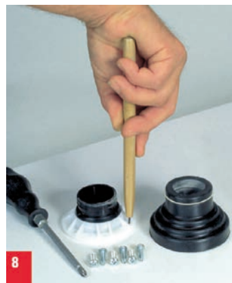
8. Löcher in der Dachdurchführung mit Vorstecher einstechen. Bei Kunststoffdächern Löcher mit Bohrer \varnothing 3,5 mm vorbohren.
